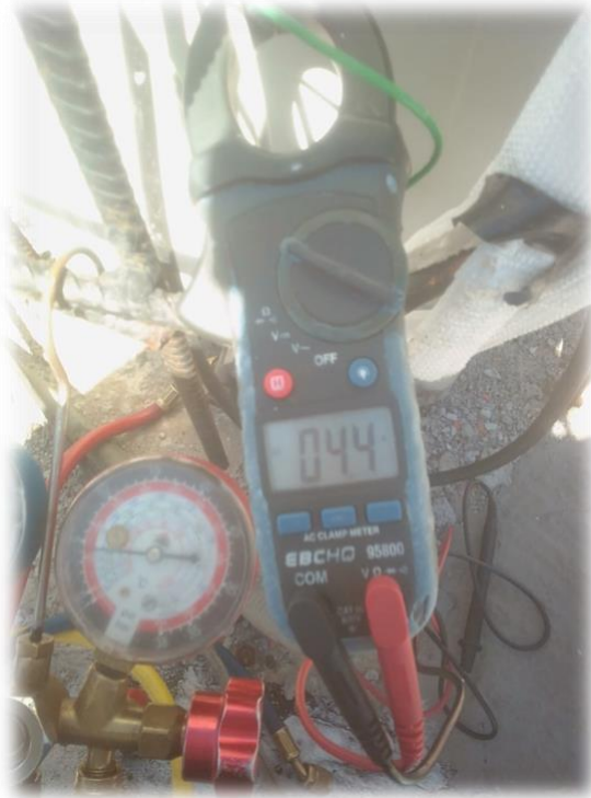
En esta imagen se puede apreciar que el amperaje del equipo y la presión de gas refrigerante están por debajo de lo requerido
